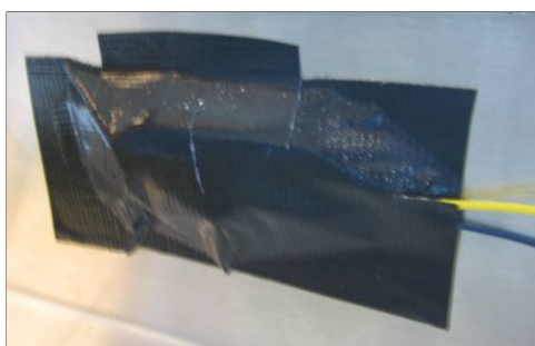
Venstre: Dioden forfra. Høyre: Diodekretsen er festet til kabinettet med tape.
